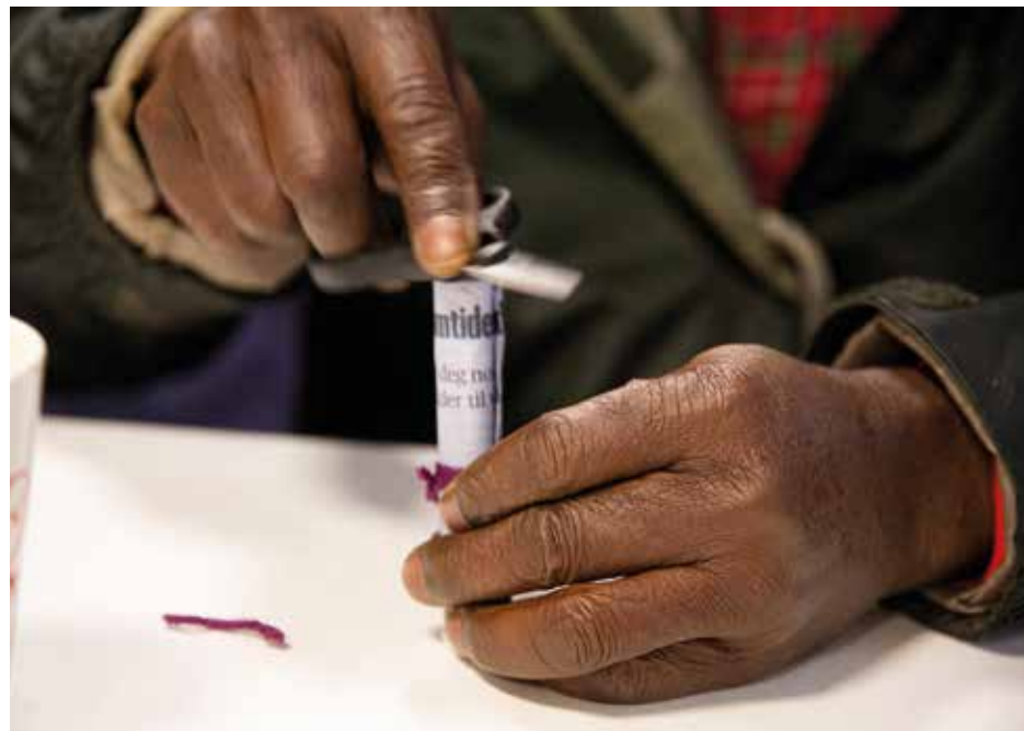
Avispapiret får Jobben fra andre institusjoner, og garnet som brukes til å knytte tennrullen er fra gjenbruksstasjonene. Tennrullene dypes i smeltet stearin fra lysstumper.
